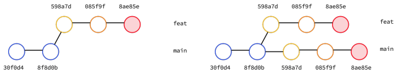
Figura: Prima e dopo un git merge feat o git rebase feat
